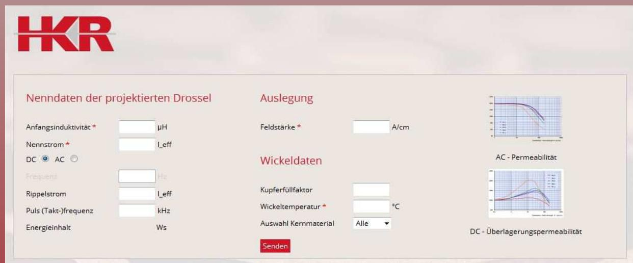
Ein Highlight der neu erstellten Seiten ist der Kern-Konfigurator. Dort kann man sich nun online die Kerne für seine spezifische Drossel errechnen lassen und erhält einen ersten Überblick welche Abmessungen zu erwarten sind. Daraus lässt sich dann direkt eine Kern-Anfrage generieren.
